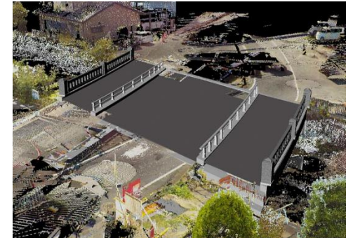
3Dモデルと点群データの重ねチェック
